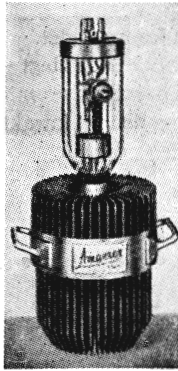
Fig. 44. Luftkølet senderør.
