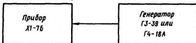
Рис. 24. Структурная схема проверки АЧХ КВО
