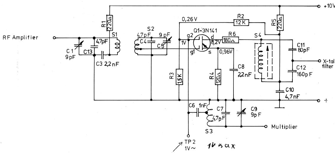
max 1,5V målt med diodesprobe
